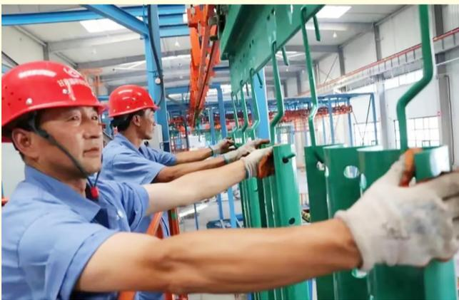
热轧卷板纵剪机组、护栏板冷弯成型机组、焊管高频焊接机组、抛丸除锈机组、自有专利技术——积放式悬挂输送系统、复合喷涂设备和粉末回收循环再利用系统等设备。积放式悬挂输送系统使立柱内壁喷涂更加均匀，同时实现了立柱、护栏板同步喷涂。全套生产线实现了从热轧卷板到成品下线的工艺集成与智能控制。
